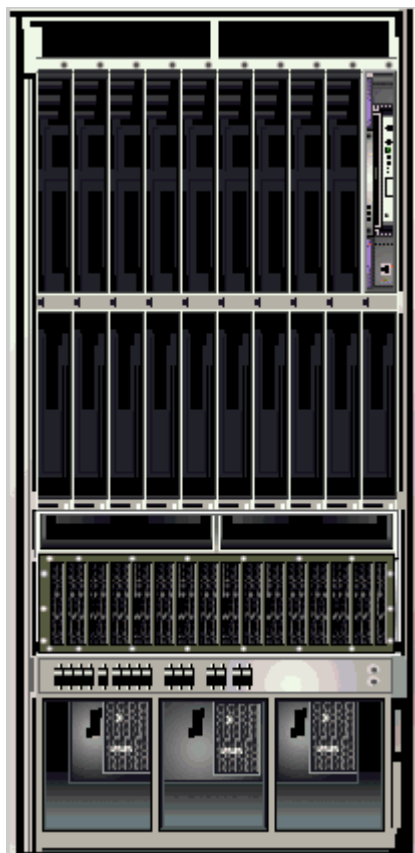
图 5-10 Sun Fire 高端系统系统控制器物理视图—正面
