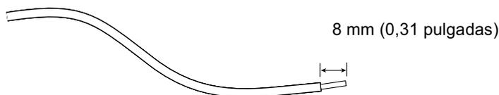
FIGURA 3-2 Cortado del aislante del cable
