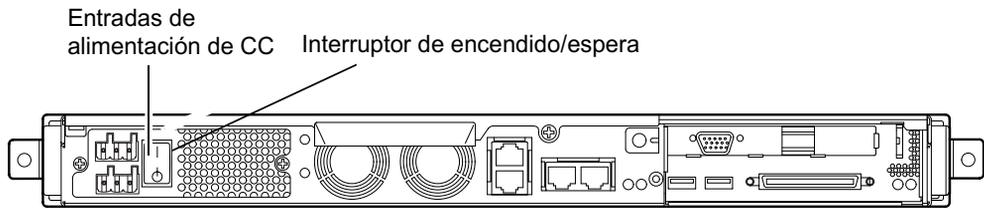
**FIGURA 7-1** Interruptor de encendido/espera del servidor Netra 120
