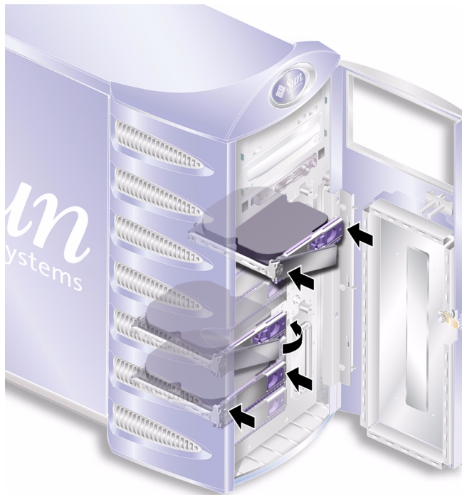
ABBILDUNG 2-3 Einbau eines Festplattenlaufwerks
