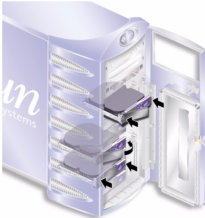
图 2-3 插入硬盘驱动器
