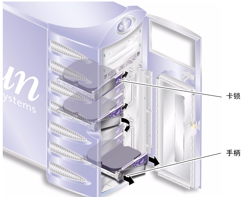
图 2-2 拆卸硬盘驱动器
