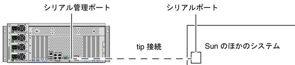
図 2-5 Sun Fire V445 サーバーと Sun のほかのシステムとの tip 接続
