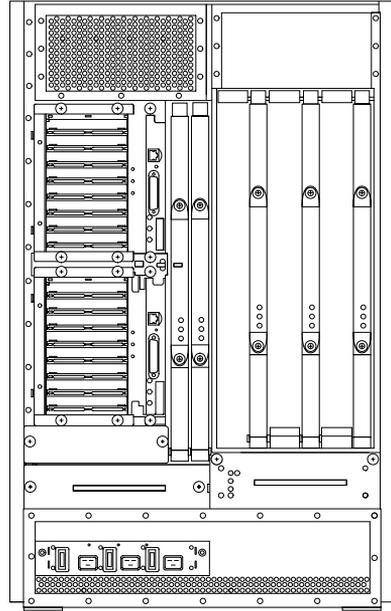
図 1-3 Sun Fire E4900 システムの正面図および背面図
