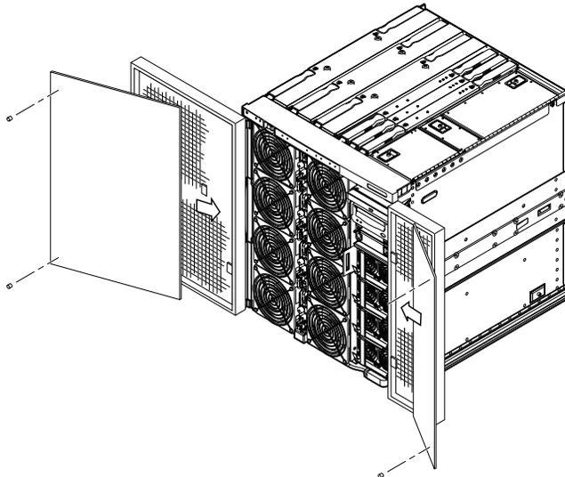
2. 新しいフィルタを取り付けて、プラスチック製のピンをふたたび取り付けます。
