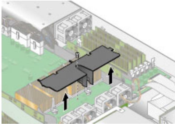
図 3-21 中央エアバッフルの取り外し
