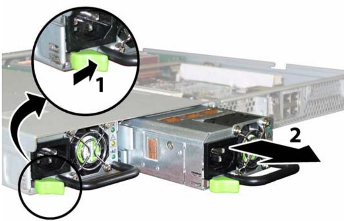
FIGURE 3-58 Retrait d'une alimentation électrique
