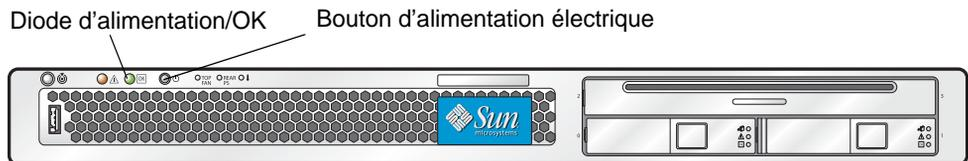
FIGURE 3-1 Emplacement du bouton d'alimentation et de la diode d'alimentation/OK
