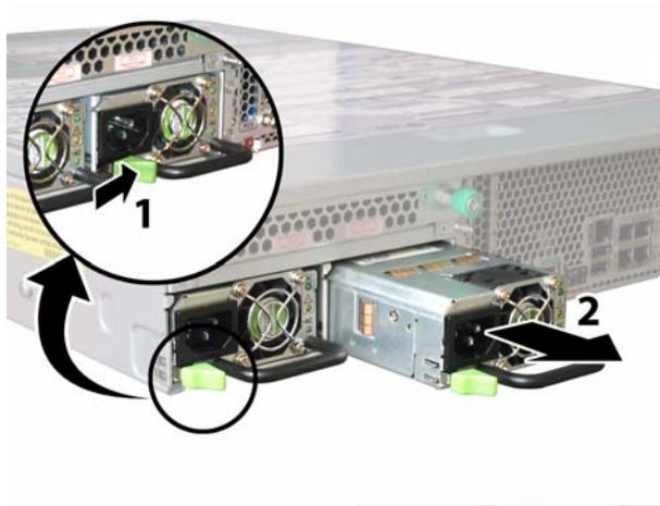
**FIGURE 4-58** Retrait d'une alimentation électrique
