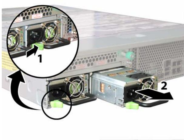
FIGURE 4-59 Retrait d'une alimentation électrique
