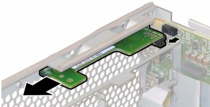
**FIGURE 4-26** Retrait de la carte des diodes du panneau avant
