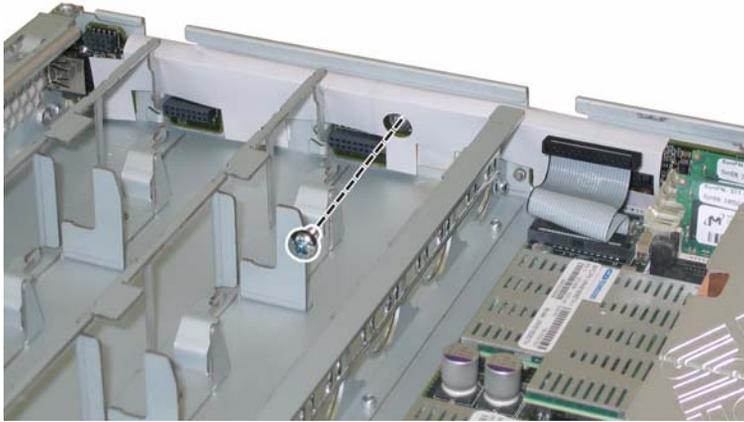
**FIGURE 3-28** Retrait de la vis de la carte d'E/S avant du châssis
