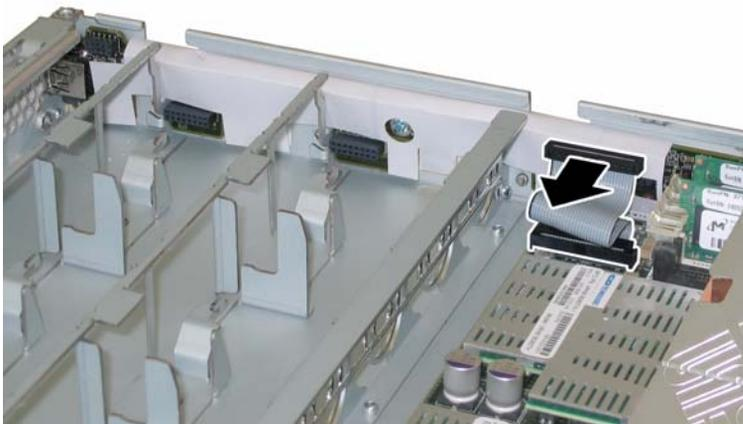
**FIGURE 3-27** Déconnexion du câble d'interconnexion de la carte d'E/S avant
