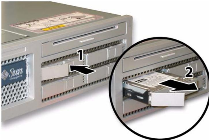
**FIGURE 4-33** Ouverture du loquet du disque dur
