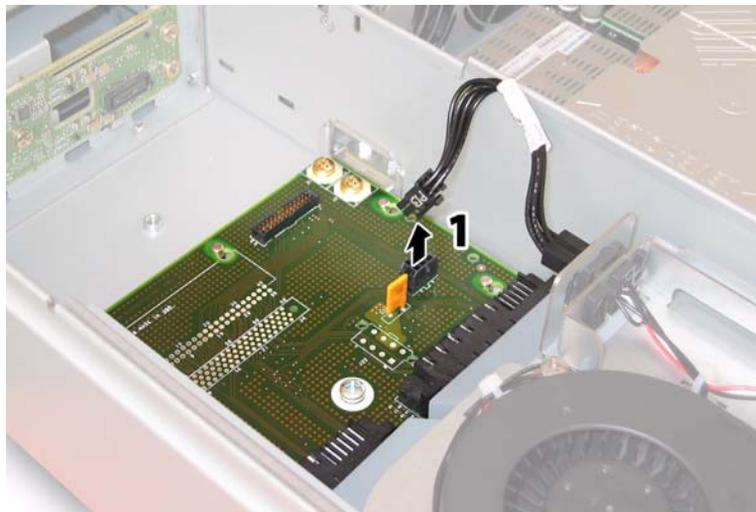
**FIGURE 4-63** Déconnexion du ventilateur arrière de la carte d'alimentation électrique
