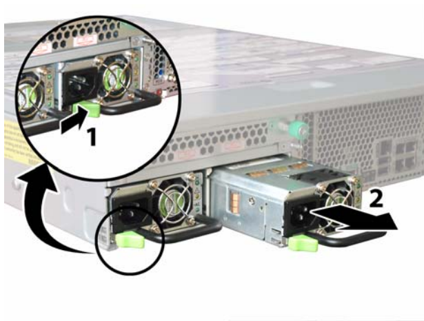
図 4-59 電源の取り外し
