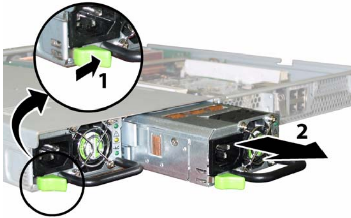
図 3-58 電源の取り外し
