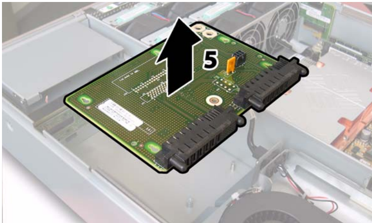
図 4-65 配電盤の取り外し
