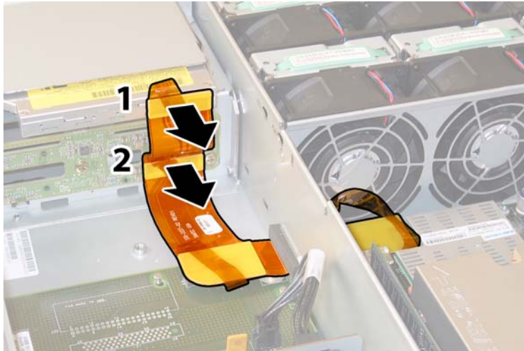
図 4-36 DVD-ROM ドライブおよび HDD バックプレーンからのフレックスケーブルの取り外し
