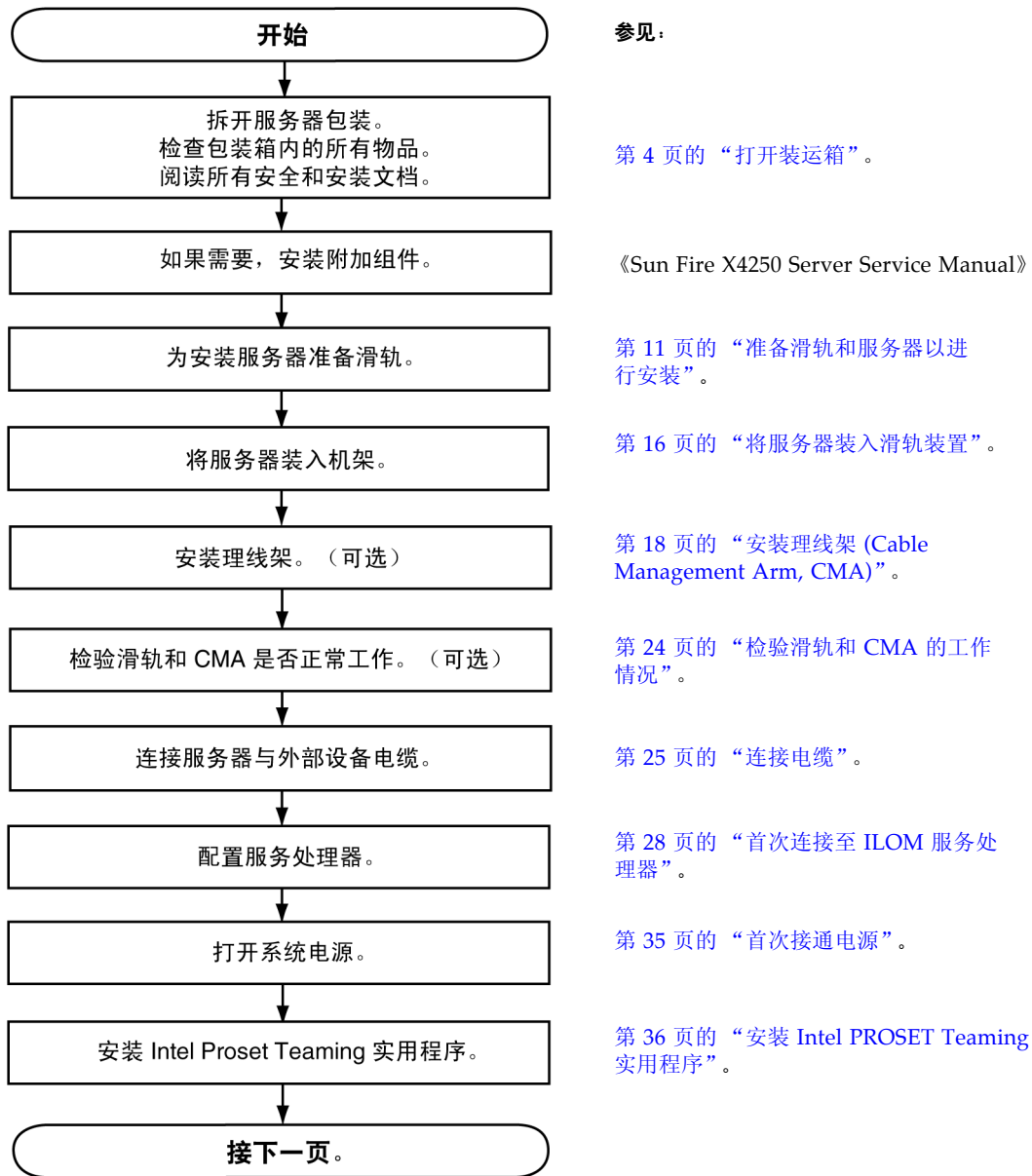
图 1-1 Sun Fire X4250 服务器安装过程（第 1 部分）
