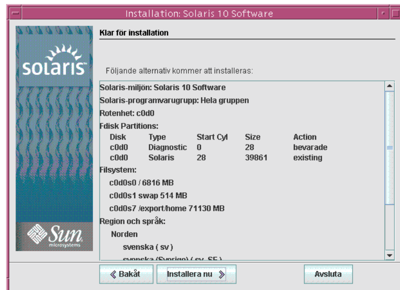
FIGUR 2-12 Fönstret Klar för installation i Solaris installationsprogram
