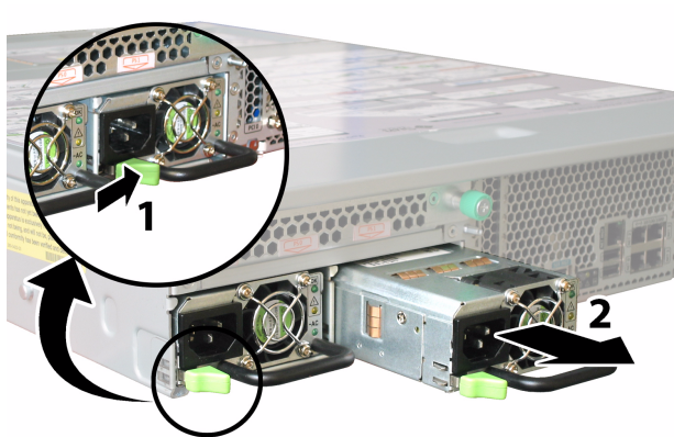
FIGURA 12-12 Extracción de una fuente de alimentación
