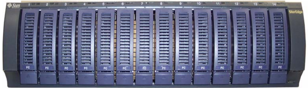
圖 1-7 具有光纖通道磁碟機的 Sun StorEdge 5300 EU F 擴充附件正面圖
