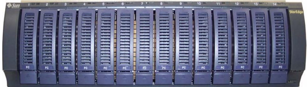
圖 1-5 具有光纖通道磁碟機的 Sun StorEdge 5300 RAID EU 控制器附件正面圖
