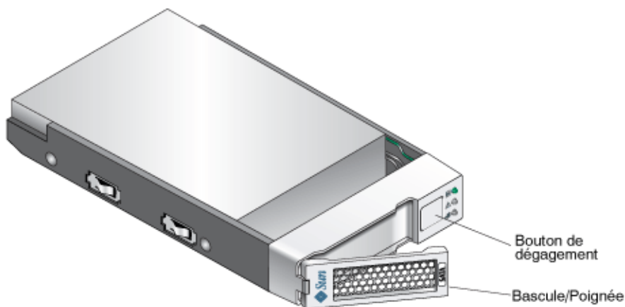
FIGURE 1 Relâchement de la poignée de la bascule
