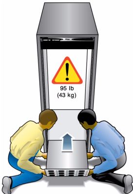
FIGURA 4 Instalación de la bandeja
