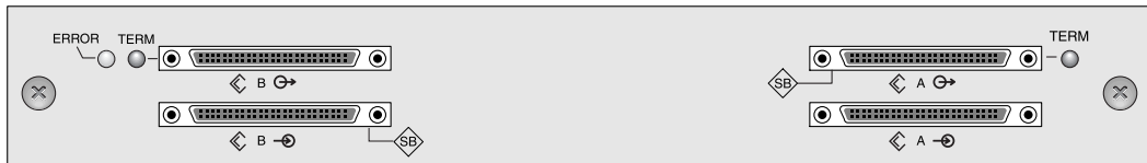
FIGURE 4-21 Configuration à bus scindé d'une unité d'extension
