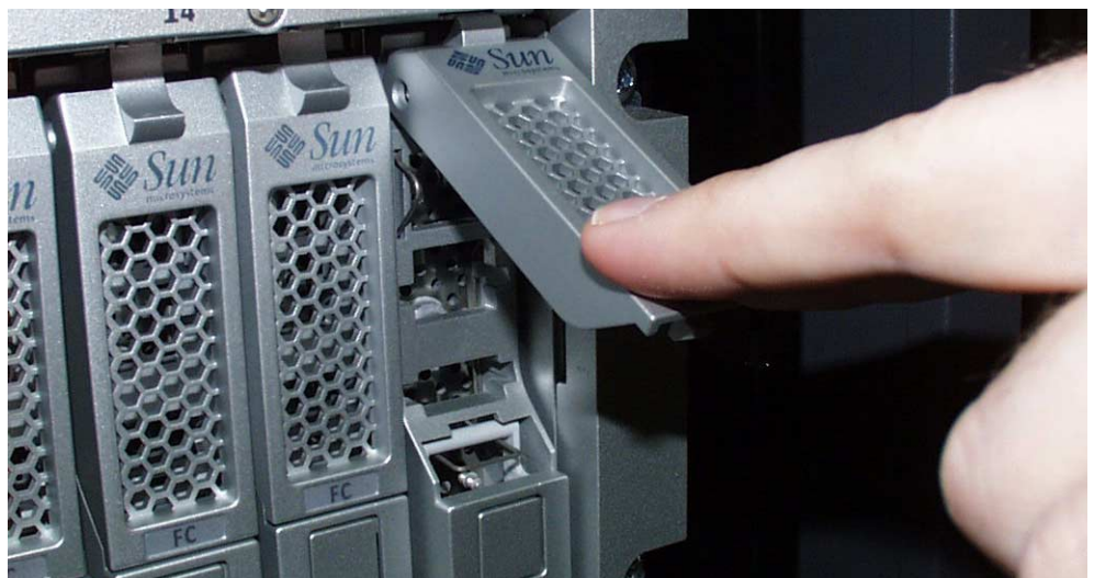
FIGURE A-1 Insertion d'une unité de disque
