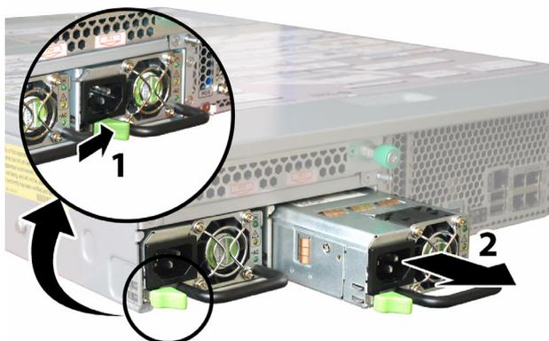
図 12-12 電源装置の取り外し
