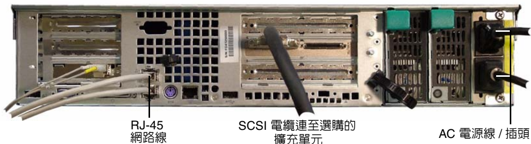
■ 2-15 連接 Sun StorEdge 5210 NAS 的 AC 電源線
