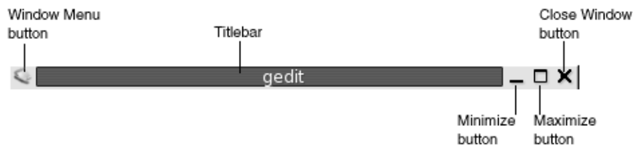
ABBILDUNG 2-2 Oberer Teil eines Rahmens für ein typisches Anwendungsfenster
