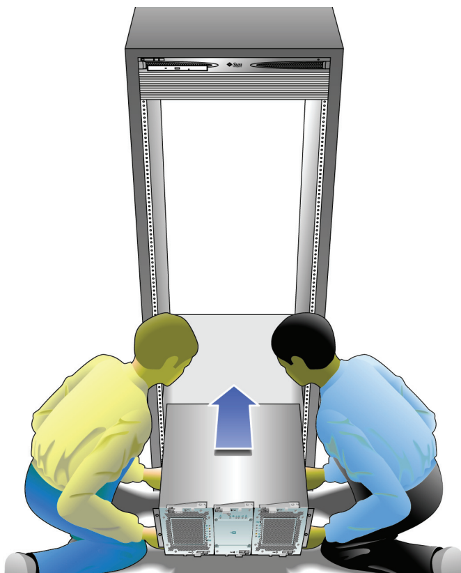
图 D-8 将控制器托盘放置在机箱机架的第 5 个插槽
