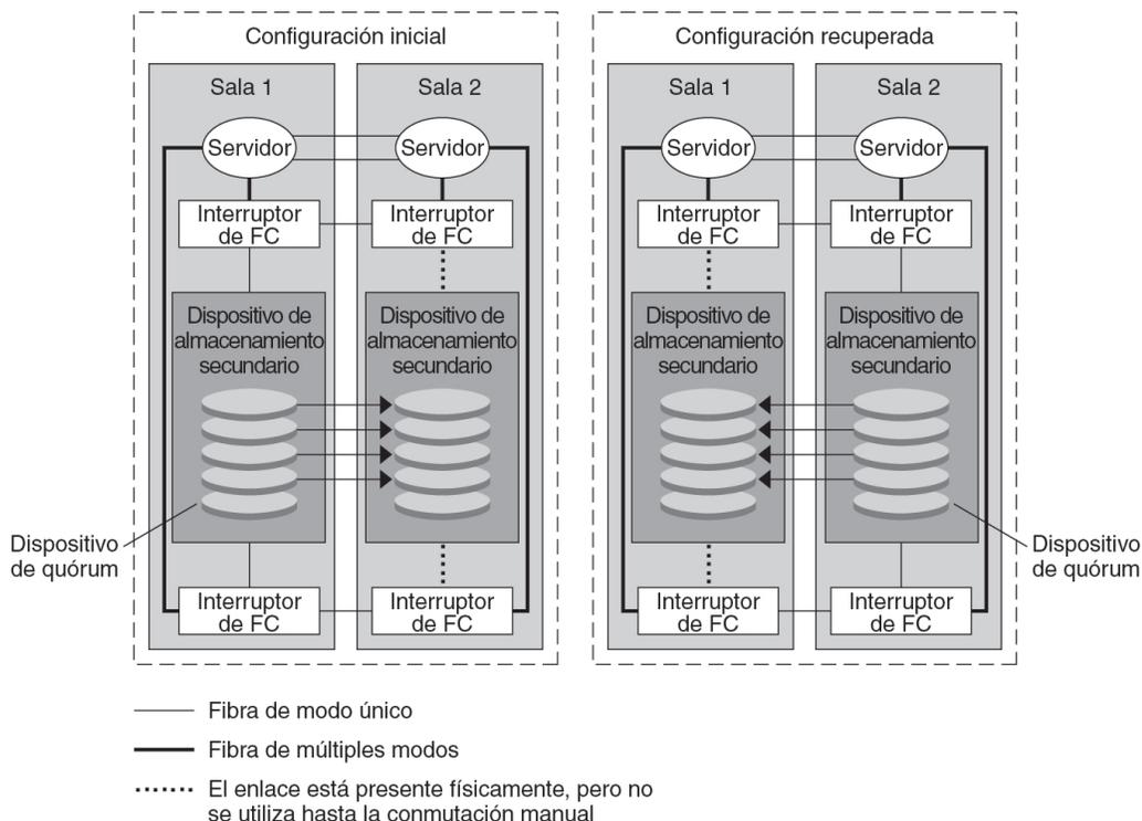
La replicación sincrónica basada en almacenamiento con EMC SRDF se admite en Oracle Solaris Cluster. La replicación asincrónica no se admite para EMC SRDF.
