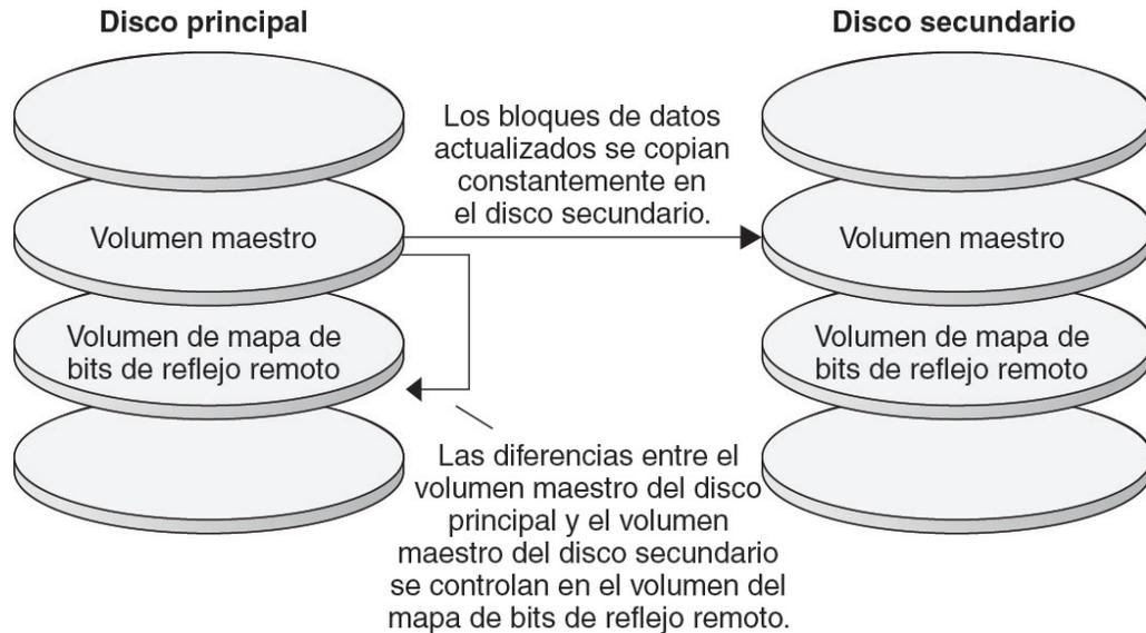
La replicación por duplicación remota se puede efectuar de manera sincrónica en tiempo real o de manera asincrónica. Cada volumen definido en cada cluster se puede configurar de manera individual, para replicación sincrónica o asincrónica.
