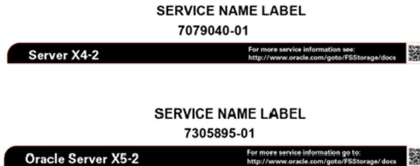
Figura 12: Etiquetas de servicio que permiten identificar el modelo de Piloto (X4-2 o X5-2)
