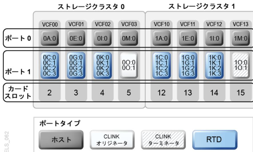
図A.5 「[VSMMPR2 - 8枚の VCF カード、8つのホストポート、24個の RTD 用の FICON ディレクタ、4つの CLINK が搭載された VSM5](#)」は、VSMMPR1 (双方向クラスタ内で8枚の VCF カードが搭載され、最大32個の RTD 機能が有効である VSM5) 用の *CONFIG* チャンネルインタフェース識別子を示しています。この構成では、次を割り当てます。
