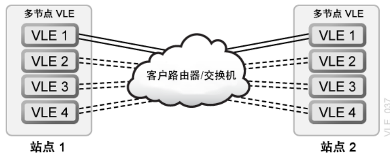
图 A.3. VLE 到 VLE 远程复制通信
