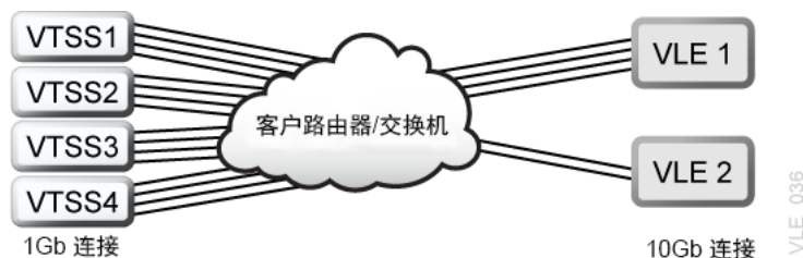
图 A.2. 具有网络基础结构的多 VTSS 到 VLE 布局
