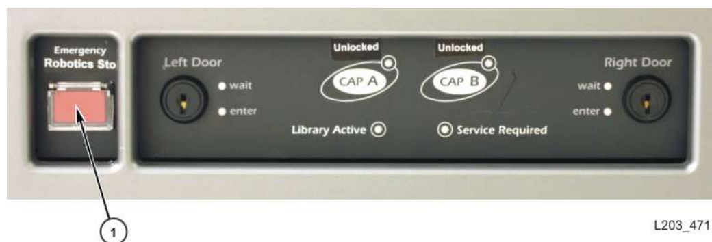
Figure 15.1. Commutateur d'arrêt d'urgence de la robotique
