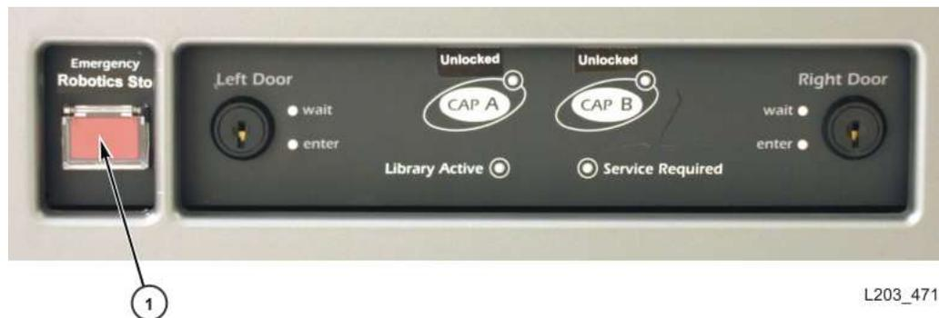
1. Switch di arresto di emergenza della robotica (ERS, Emergency Robotic Stop)
