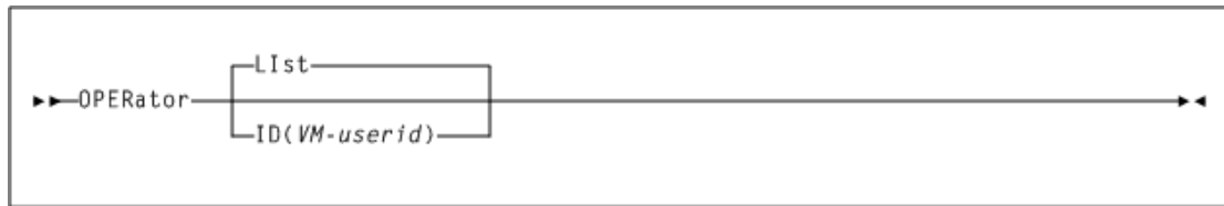
Figure 6.18. Syntaxe de la commande OPERator
