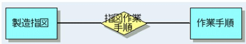
集約演算子は、関係にも適用できます。既存の関係タイプを1つのエンティティタイプとして扱うと、それが新しい関係を作成する際の起点になります。図4-12に、例を示します。
