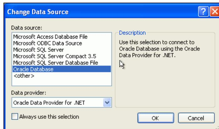
5. 「Oracle Database」を選択してから、「Oracle Data Provider for .NET」を選択します。
