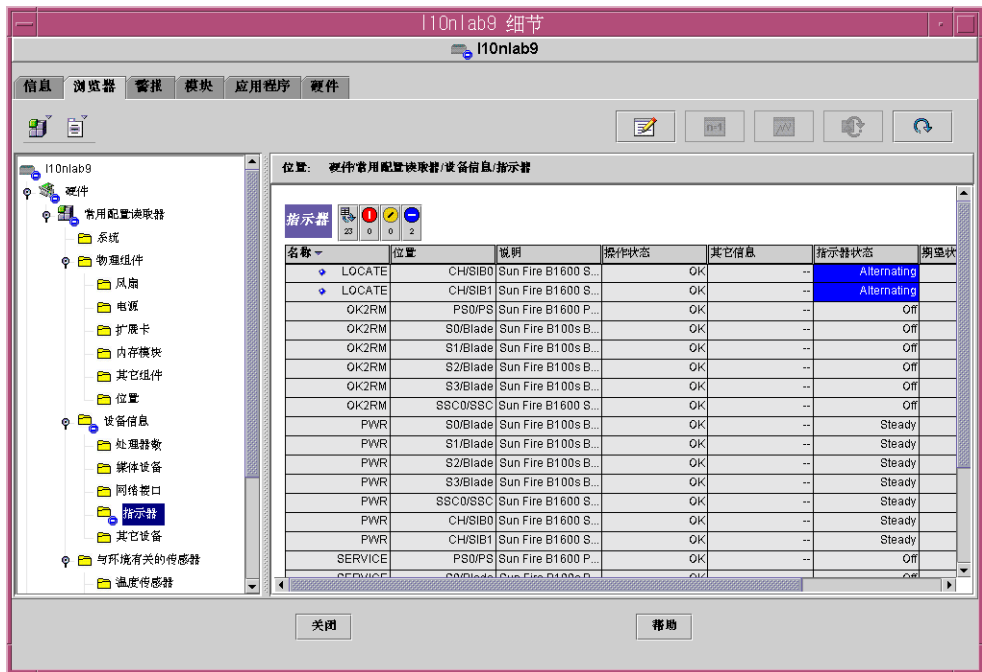
图 4-2 显示有指示符的逻辑设备表（部分）
