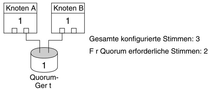
ABBILDUNG 3-2 Zwei-Knoten-Konfiguration
