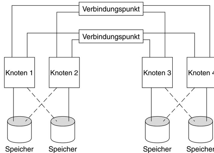
**ABBILDUNG 2-2** SPARC: Geclusterte-Paare-Topologie
