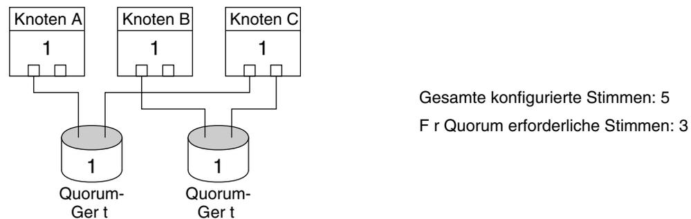
In dieser Konfiguration sind die Anwendungen in der Regel für die Ausführung auf Knoten A und Knoten B konfiguriert und verwenden Knoten C als Hot-Spare.
