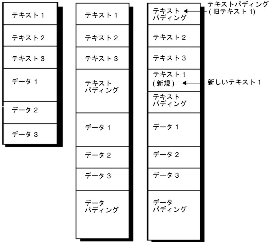
図 4-1 インクリメンタルリンク処理の例
