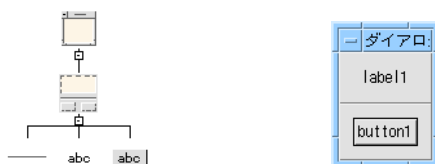
図 2-19 2 つめのウィンドウの階層およびデフォルトのダイナミックディスプレイ ラベルおよびプッシュボタン上にテキストを設定します。
