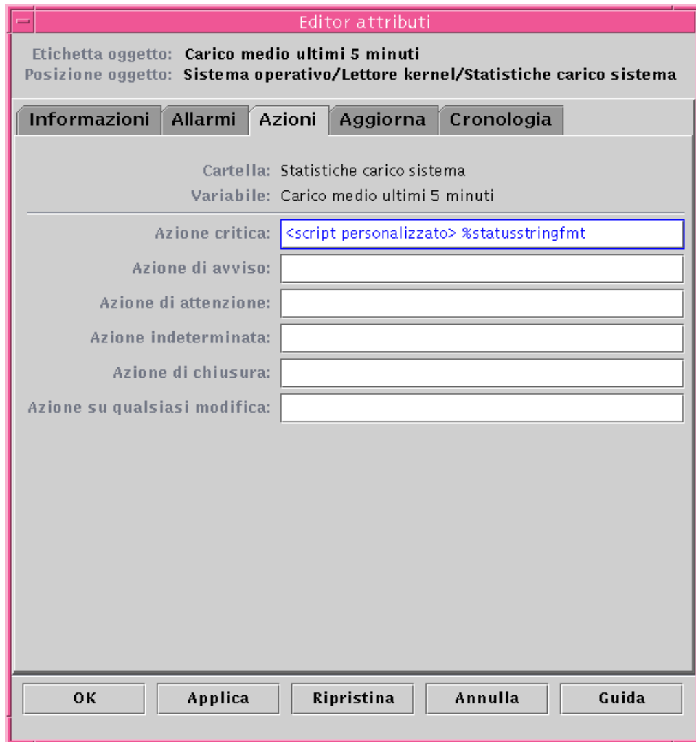
FIGURA 10-5 Definizione di uno script personalizzato per l'azione da eseguire in caso di allarme nella finestra dell'Editor attributi
