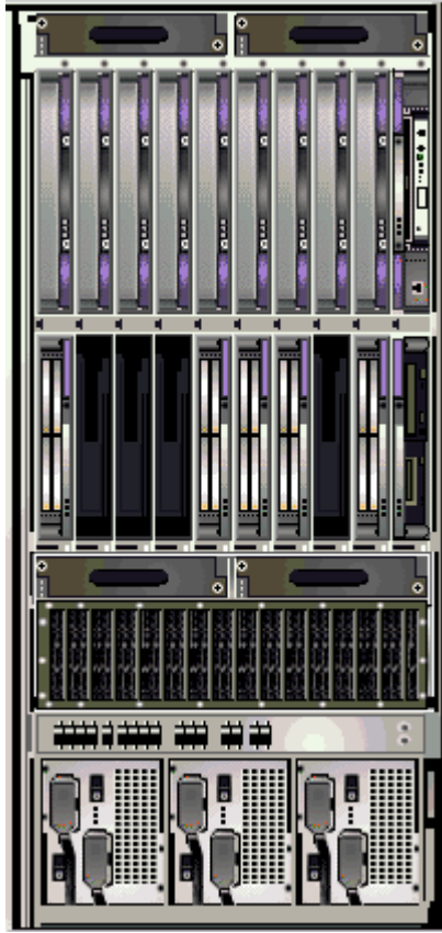
그림 5-2 Sun Fire 15K/12K 플랫폼 물리적 보기—앞면
