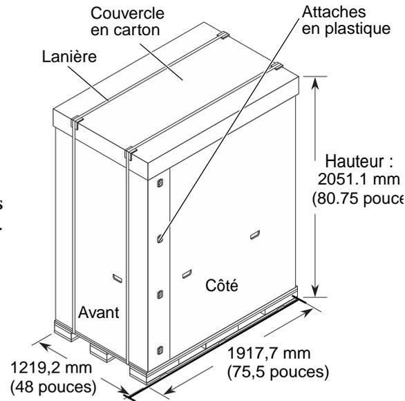
3. Placez l'armoire dans son emballage le plus près possible de son emplacement définitif. Pour déplacer l'armoire de la palette, le long des rampes, les quatre côtés de l'armoire doivent être dégagés, avec un espace minimum de 5,49 m.
