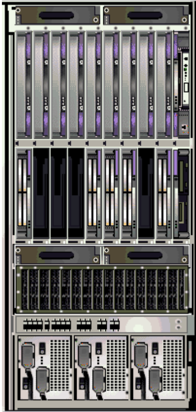
図 5-2 Sun Fire ハイエンドシステムのプラットフォームの物理表示 - 正面
