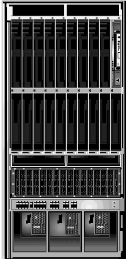
그림 5-10 Sun Fire 최고급 시스템 SC 물리적 보기 — 앞면
