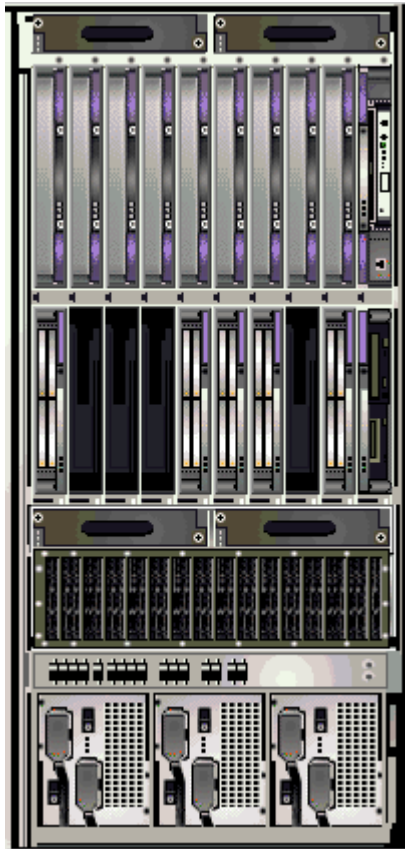
圖 5-2 Sun Fire 高階系統平台實體視區 — 正面
