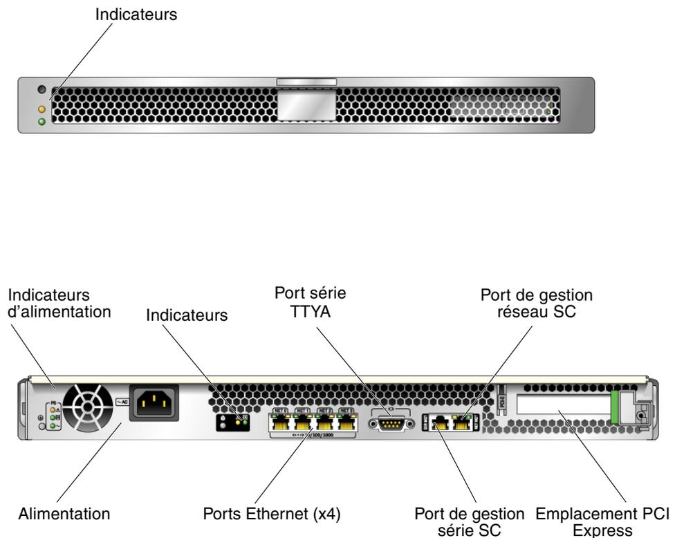
**FIGURE 3** Panneaux avant et arrière du serveur Sun SPARC Enterprise T1000
