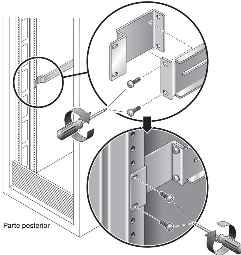
**FIGURA 2-5** Uso de la pieza de extensión
