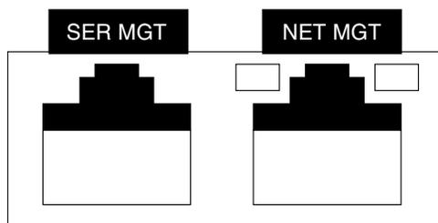
FIGURA 2-10 Puerto serie de administración y puerto de red del controlador del sistema, parte posterior del chasis
