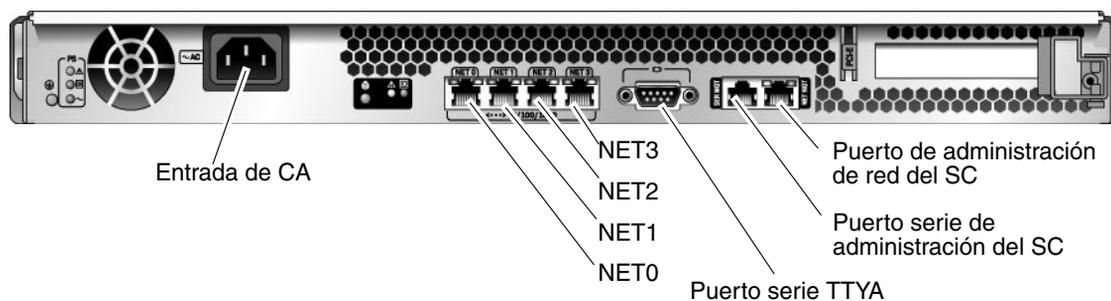
FIGURA 2-9 Conectores del panel posterior
