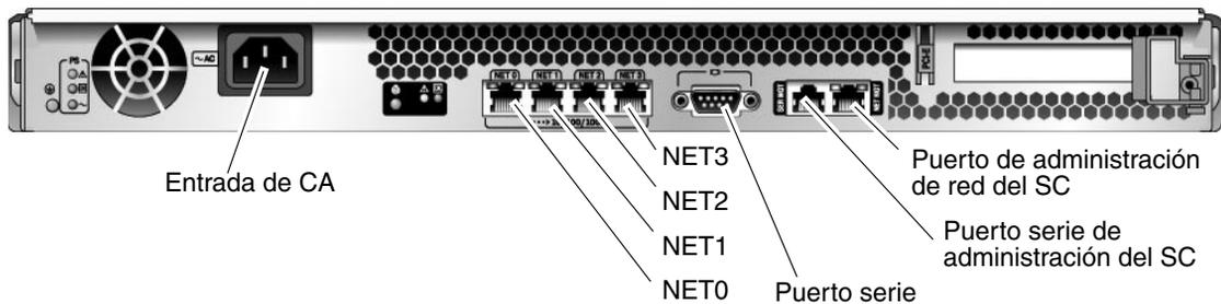
**FIGURA 1-5** Ubicación de los puertos y conectores del panel posterior
