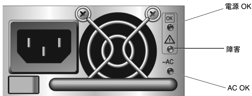
図 3-5 電源装置の LED
