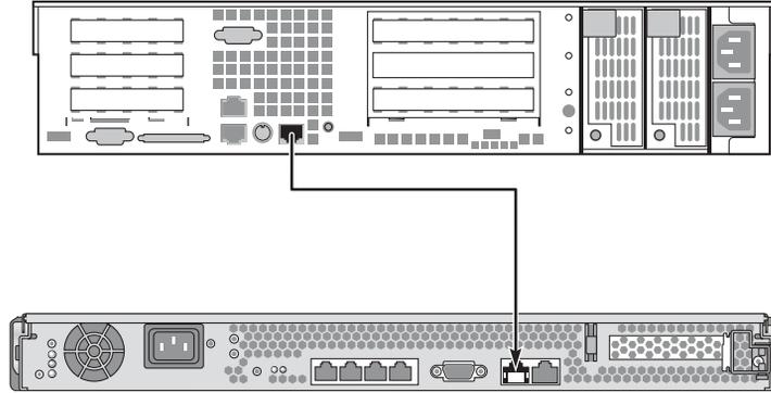
그림 1-4 서버와 다른 Sun 시스템 간 TIP 연결
