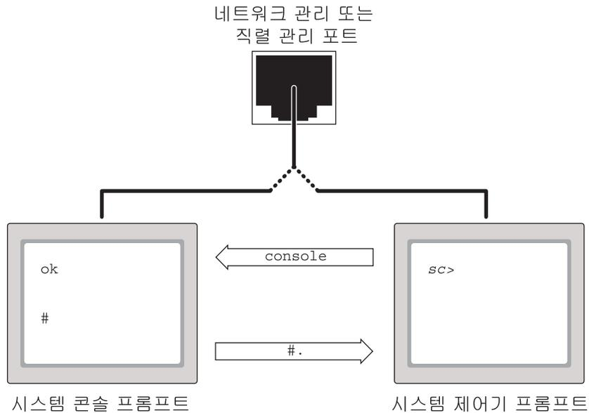
그림 1-5 시스템 콘솔과 시스템 제어기 프롬프트 간의 전환
