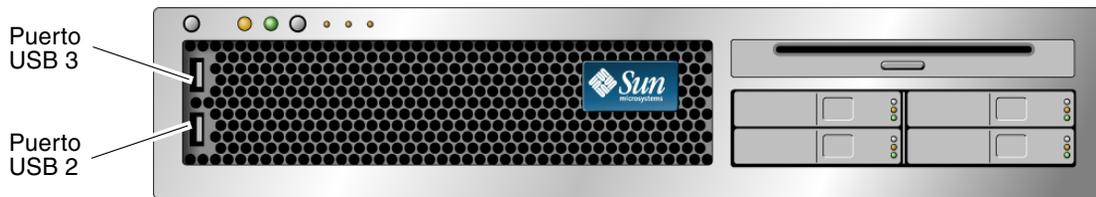
**FIGURA 1-3** Puertos USB del panel frontal
