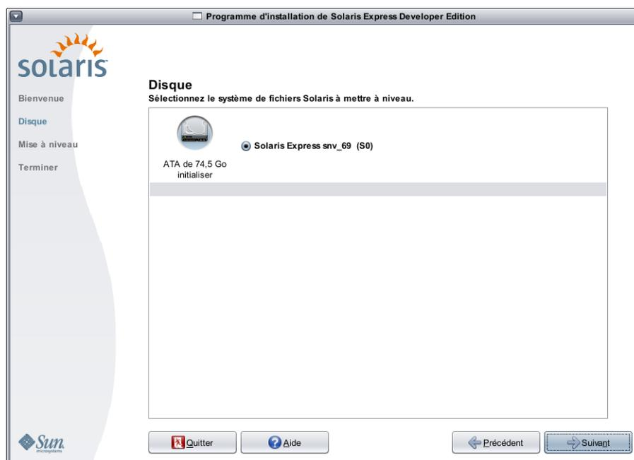
Ce panneau affiche les disques internes, les disques externes et les disques durs électroniques disponibles sur le système. Pour être reconnus par le programme d'installation, les disques et les disques durs électroniques doivent être sous tension lors de l'initialisation de l'ordinateur.
