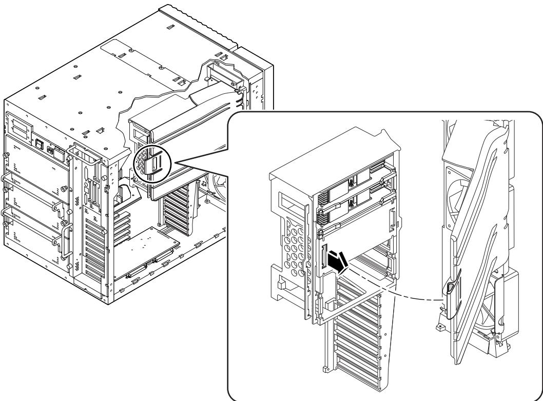
**2. 将导气片接头从 CPU 风扇架的插槽上卸下。**
