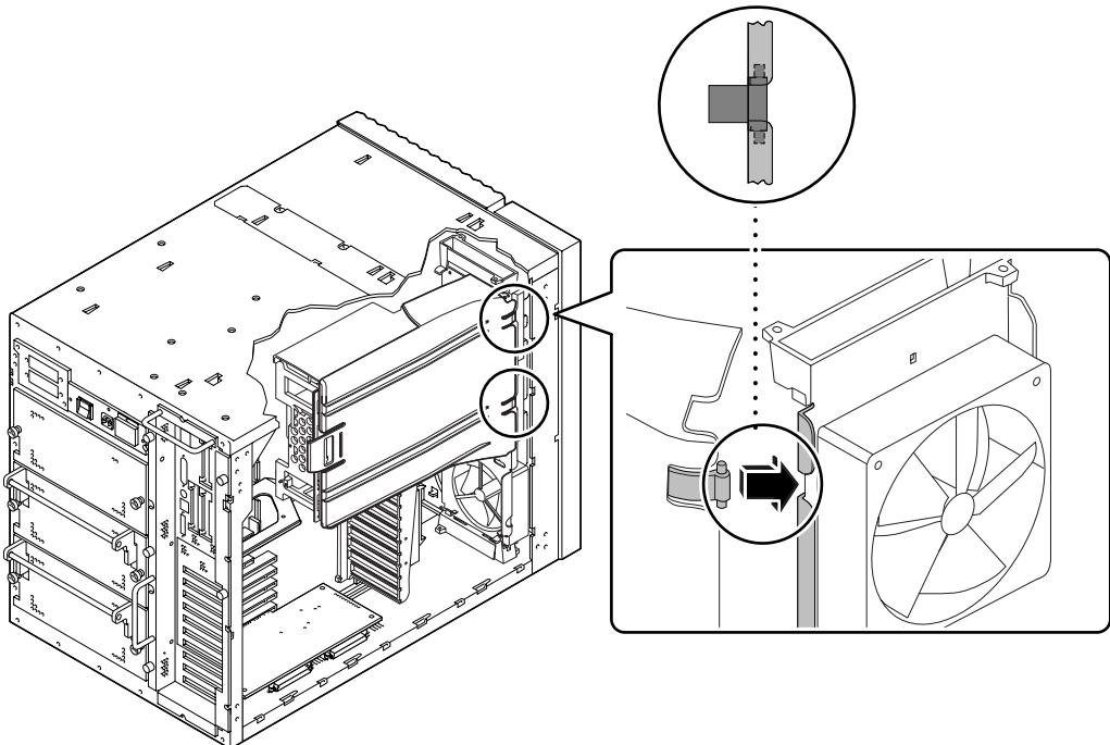
2. 将导气片滑向底板的后部以保证导气片接头与 CPU 风扇架连接稳固。
