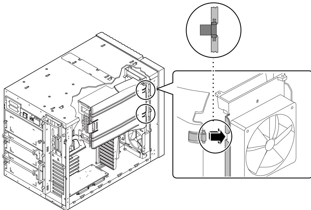
**2. 將空氣導引朝基座後方滑進去使它的勾環在 CPU 風扇托盤裝配上掛好。**
