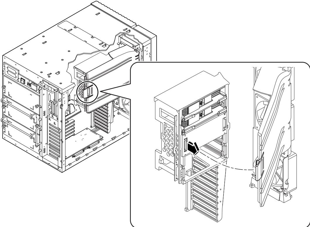
**2. 將空氣導引的卡榫從 CPU 風扇托盤裝配中取下。**
