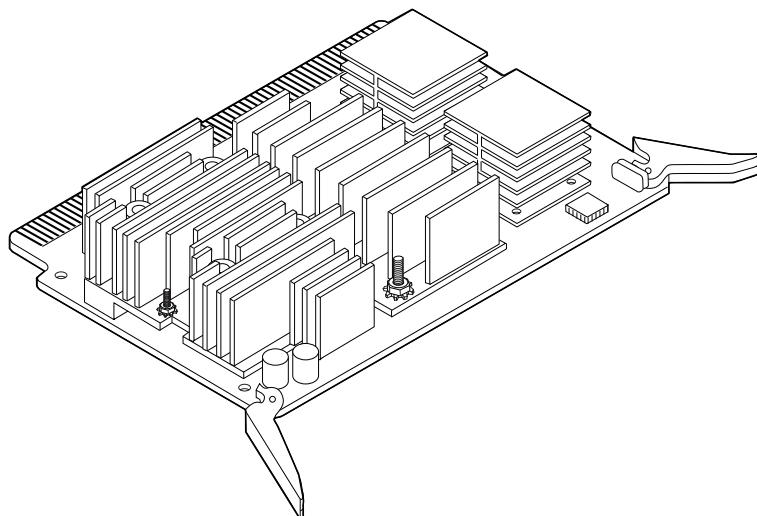
安裝 CPU 模組之前，驗證每塊新的模組是 Sun Enterprise 450 伺服器的下列 UltraSPARC II 模組型號之一。下表辨識出 CPU 模組速度。
