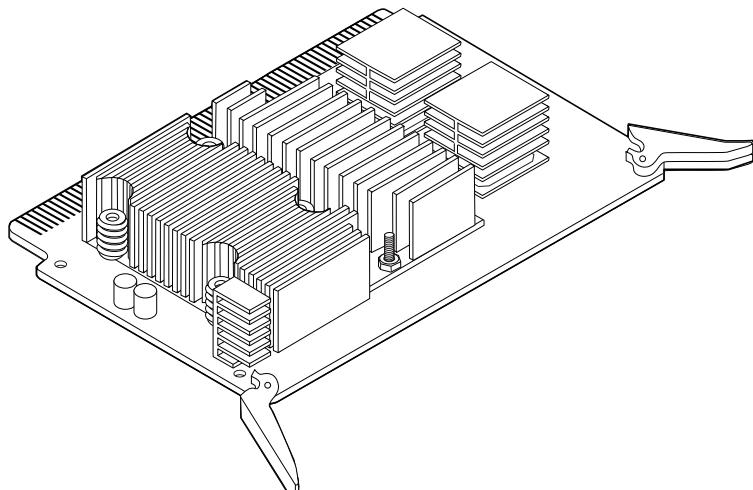
安装 CPU 模块之前，验证每块新的模块都是 Sun Enterprise 450 服务器系统的下列 UltraSPARC II 模块型号之一。下表标识出 CPU 模块速度。
