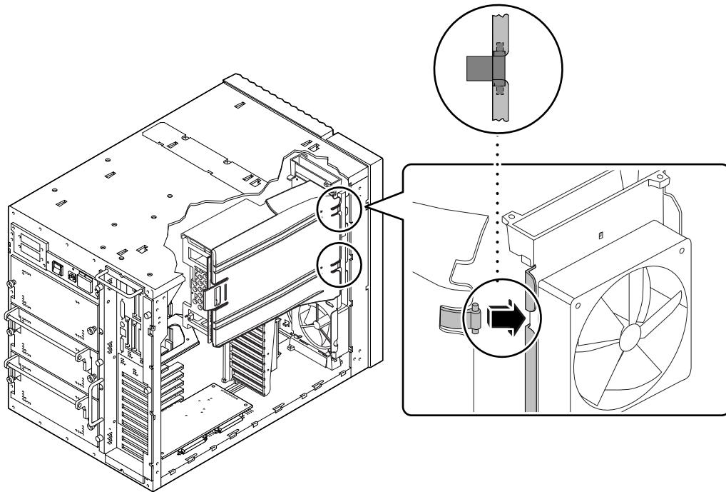
2. シャーシの背面方向にエアガイドをスライドさせて、CPU ファントレイ部品にエアガイドのタブを固定させます。
