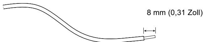
ABBILDUNG 3-2 Abisolieren des Drahtes
