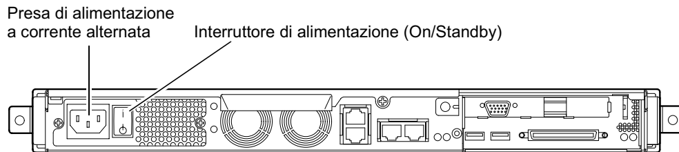
FIGURA 7-2 Interruttore di alimentazione (On/Standby) del server Sun Fire V120
